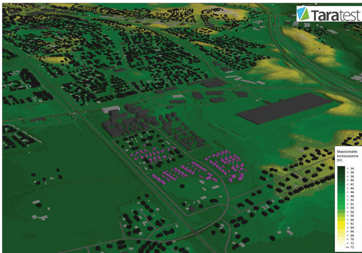
Kuva 4. Ote laskennassa käytetystä maastomallista sekä huomioidut rakennusmassat.
